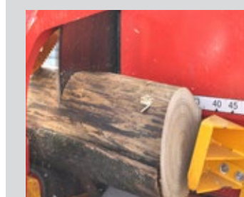
Circular saw with carbide teeth HM-Sägeblatt mit Karbidverzahnung Cuchilla de sierra con dientes de carburo
