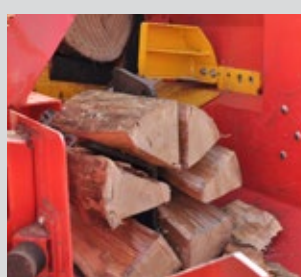
Splitting wedge, hydraulically adjustable Spaltkreuz mit hydraulischer Höheneinstellung Filo astillas hidráulicamente ajustable
