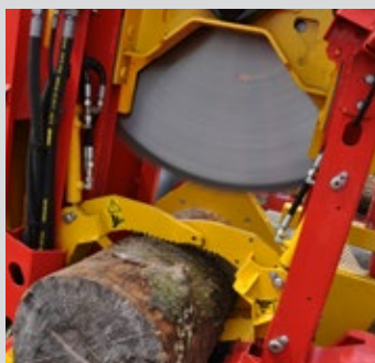
Double hydraulic grip holding the wood Doppelte Stammklemme für eine optimale Halten der Stämme Doble pinza independiente para el mantenimiento del tronco
